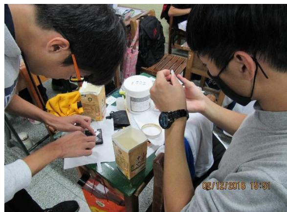
修整模型-黏合模型與新鮮屋-噴灑離型劑-1:1 調合矽膠與硬化劑-灌模
