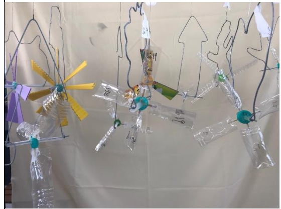
15.風車扇葉材質有保特瓶和塑合板(PP板)
