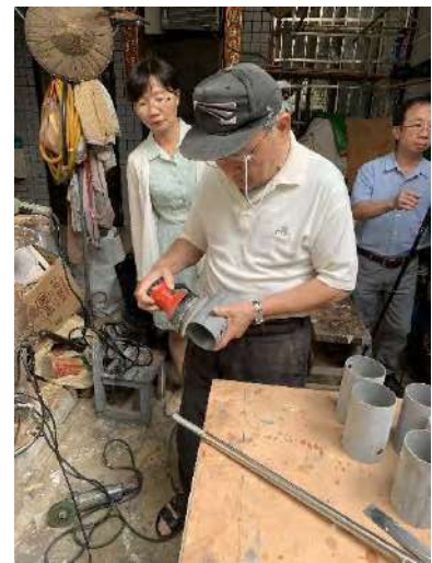
因為琴身太光滑，比較不容易上色，因此老師教導大家用磨砂機把水管表面磨粗
