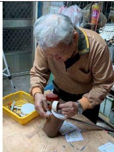
用紙膠帶將弦與螺帽黏住，防止弦脫落
