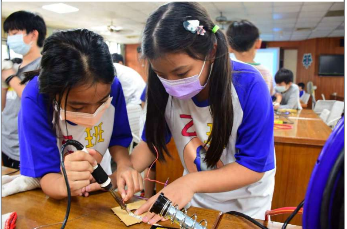
圖十二 說明:學生進行 LED 燈條與 USB 線的焊接
