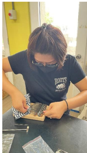
琴身組裝金屬彈片 2 使用導具輔助鋼片
